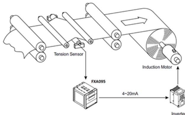
El control de Tensión FXA095 es aplicación diseñada específicamente para controlar con precisión de tensión para bobinado y des bobinado.
